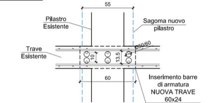
Realizzare su ciascun nodo trave-pilastro, tramite carotatura e prestando molta attenzione a non interferire con i ferri esistenti delle travi stesse, 6 asole passanti per inserimento ferri d'armatura longitudinale delle nuove travi, così suddivise:
