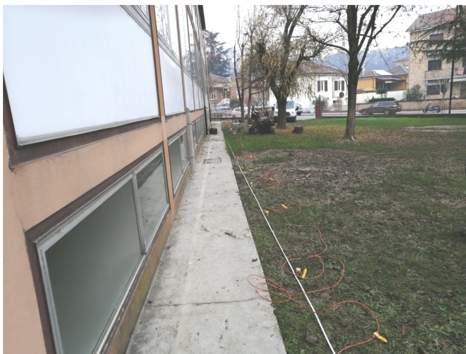
Foto 3.4 – Strumentazione utilizzata per l'esecuzione delle indagini MASW. Particolare dell'allineamento sismico, in corrispondenza del lato SE della sede scolastica in oggetto.
