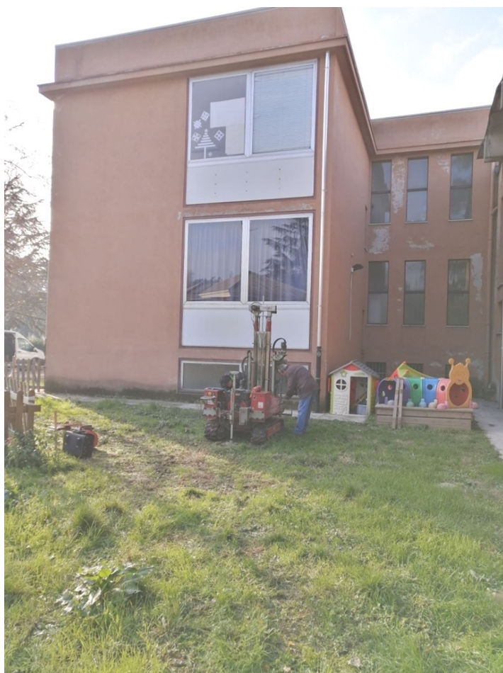
Foto 3.3 – Strumentazione utilizzata per l'esecuzione delle prove penetrometriche statiche: penetrometro superpesante Pagani TG 63/200 in corrispondenza della verticale C.P.T. 3.
