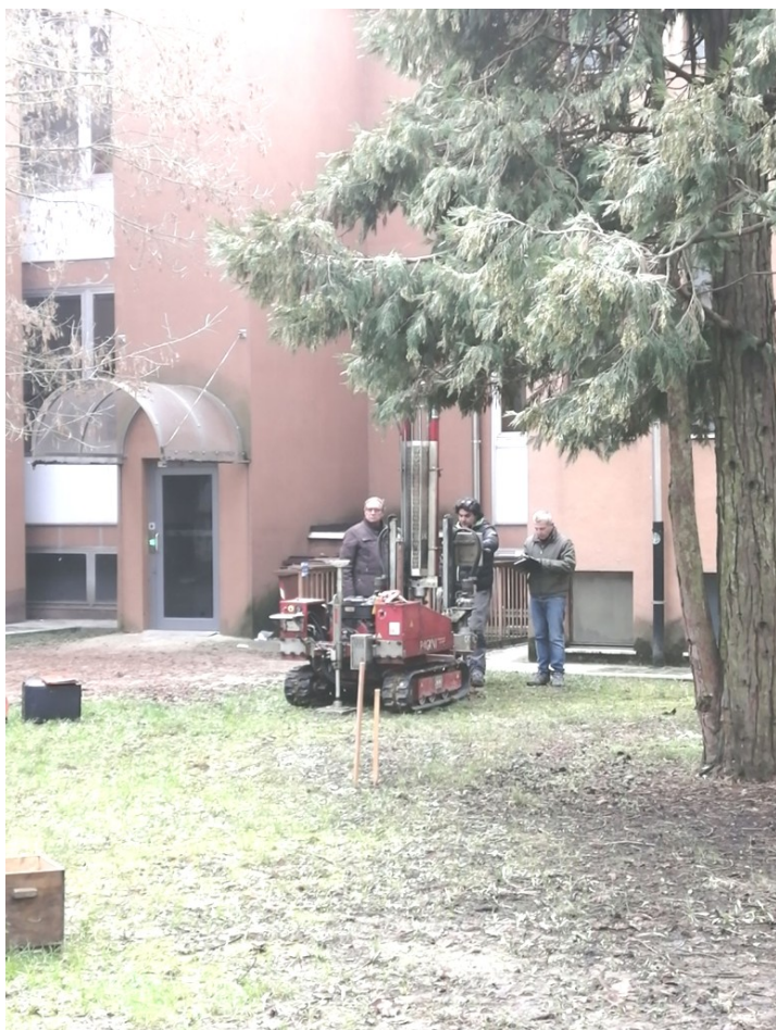
Foto 3.2 – Strumentazione utilizzata per l'esecuzione delle prove penetrometriche statiche: penetrometro superpesante Pagani TG 63/200 in corrispondenza della verticale C.P.T. 2.
